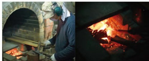
炎の色を見ながら、加熱しては叩く、また加熱しては叩く、という作業を繰り返す。辺りにカーン、カーンという音が響く。
